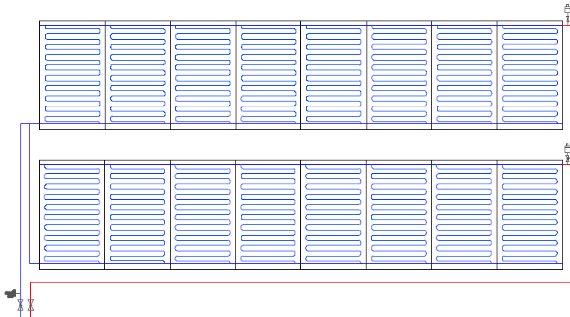
Figura 1: Esquema hidráulico de colectores de meandro en dos baterías en paralelo con retorno invertido, con ocho colectores cada uno en paralelo. Los tubos de vacío de caudal directo y heat pipe pueden conectarse de manera similar, con la única diferencia que los colectores entre sí están conectados en serie en vez de en paralelo.
